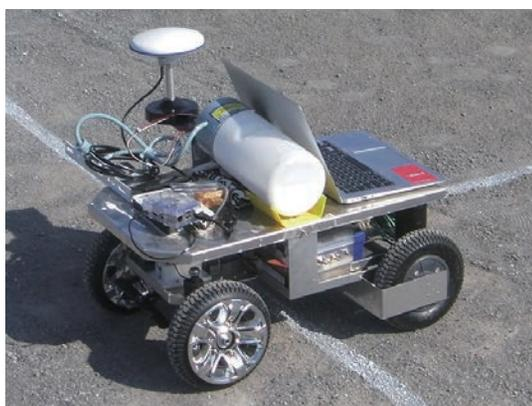
写真1 「RTK測位を活用した屋外向け高精度自動走行ロボット」
