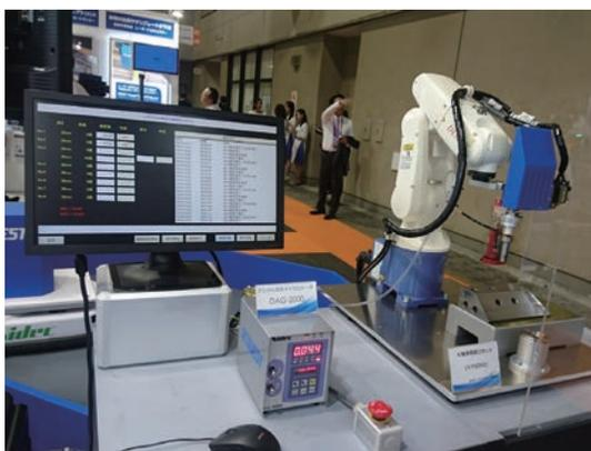
写真2 「エアマイクロ自動内径測定器」
