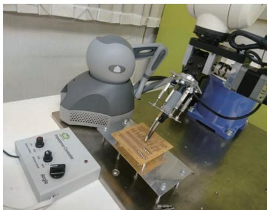
写真3 「インピーダンス制御(力制御)を利用したはんだ付けシステム」
